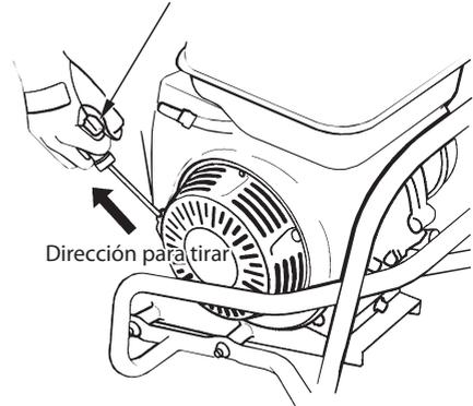
7. Si se ha movido la palanca del estrangulador a la posición CERRADO para arrancar el motor, muévala gradualmente a la posición ABIERTO a medida que se va calentando el motor.
