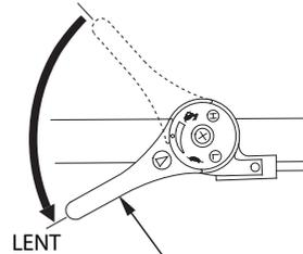
3. Placer le contacteur moteur sur la position ARRET.
