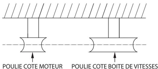
7. Serrer le levier d'embrayage et régler le jeu entre les arrêts de courroie comme illustré.
