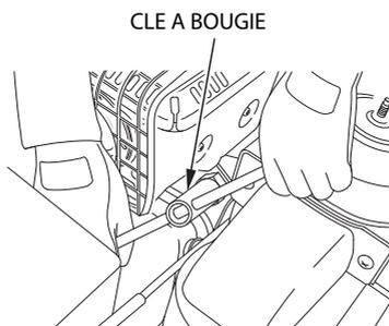
4. Contrôler la bougie. La remplacer si les électrodes sont usées ou si l'isolant est fendillé ou écaillé.
