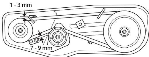
8. Una vez completado el ajuste, apriete con seguridad los pernos de los toques de la correa y los pernos de montaje del motor.
