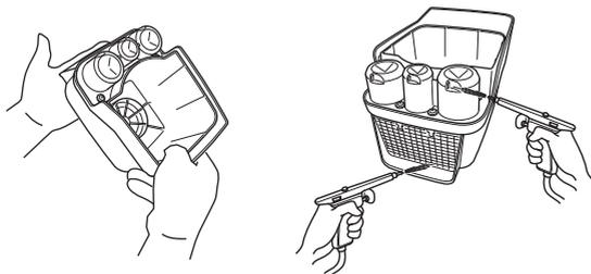
7. Essuyer la saleté à l'intérieur du boîtier et du couvercle de filtre à air à l'aide d'un chiffon humide. Veiller à ce que la saleté ne pénètre pas dans le conduit d'air menant au carburateur.
