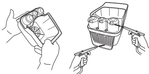
7. Frote la suciedad desde el interior de la cubierta del filtro de aire y la cubierta empleando un paño humedecido. Tenga cuidado para evitar que la suciedad se introduzca en el conducto de aire que va al carburador.
