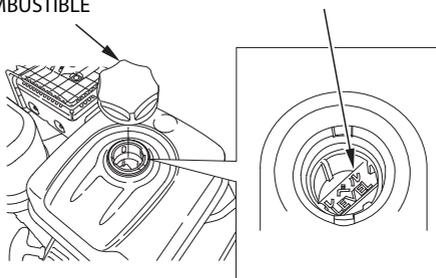
Reposte en un lugar bien ventilado antes de arrancar el motor. Si el motor ha estado funcionando, déjelo enfriar. Reposte con cuidado para que no se derrame combustible. No reposte por encima de la marca de nivel de combustible. Después de repostar, apriete la tapa del depósito de combustible con seguridad.
