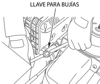
4. Inspeccione la bujía. Sustituya la bujía si los electrodos están gastados o si el aislante está rajado o astillado.
