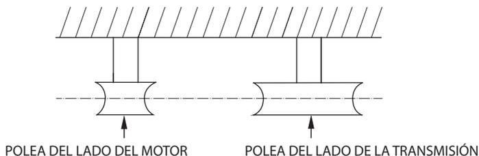
7. Presione la palanca del embrague y ajuste la holgura entre los topes de la correa, tal y como se muestra.
