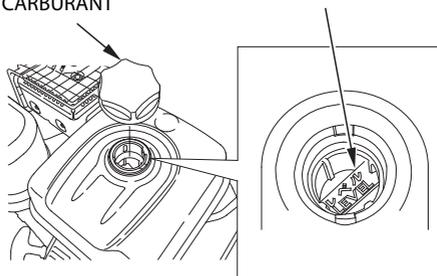
Faire le plein de carburant dans un endroit bien aéré avant de mettre le moteur en marche. Si le moteur vient de tourner, le laisser refroidir. Faire le plein avec précautions pour éviter de renverser du carburant. Ne pas remplir le réservoir de carburant au-dessus du repère de niveau de carburant. Après avoir fait le plein, resserrer le bouchon du réservoir de carburant à fond.
