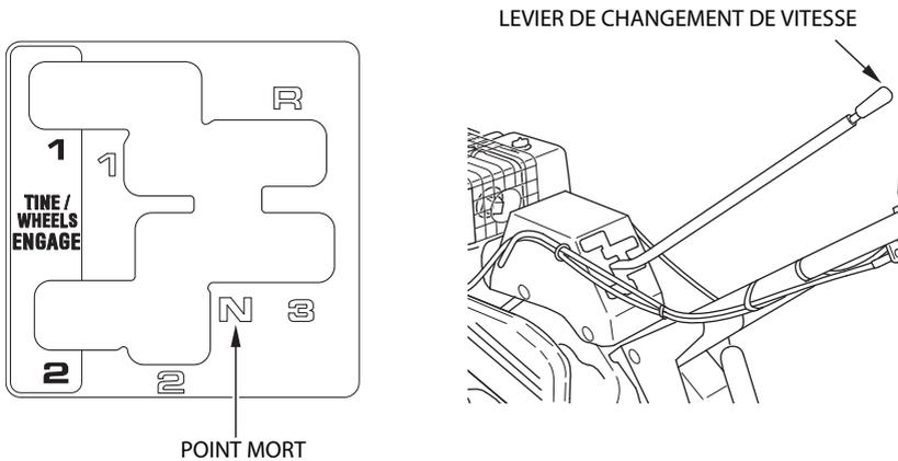
Tableau de sélection des vitesses (levier des gaz en position RAPIDE)
