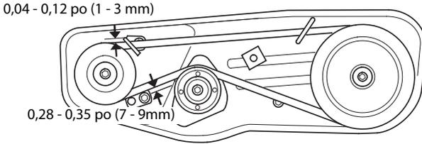
8. Après avoir terminé le réglage, serrer à fond les boulons des arrêts de courroie et les boulons de support moteur.
