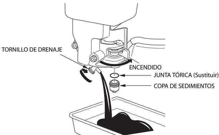
3. Tras vaciar todo el combustible del recipiente, apriete el tornillo de drenaje.
