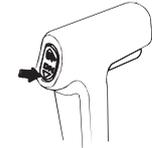
Con el motor fueraborda trimado alto, el medidor de trimado indicará tal como se muestra. Para bajar el casco, reduzca el ángulo de trimado del motor fueraborda presionando la parte DN (abajo) del interruptor de trimado/inclinación motorizados.
