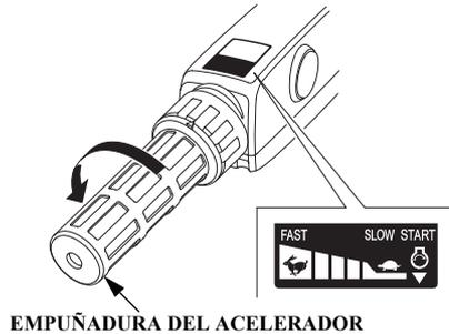
Gire la empuñadura a la izquierda o a la derecha para ajustar el régimen del motor. Al girar la empuñadura en la dirección de la flecha se incrementa el régimen del motor.
