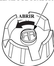
3. Gire la perilla de ventilación de la tapa de relleno de combustible totalmente hacia la izquierda para abrir el respiradero.
