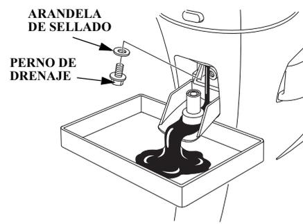
4. Extraiga el perno de drenaje de aceite de motor y arandela de sellado usando la llave de 12 mm y drene el aceite de motor.
