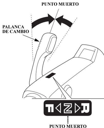
2. Mueva la palanca de cambios a la posición NEUTRAL. El motor no arrancará a menos que la palanca de cambios esté en la posición de PUNTO MUERTO.
