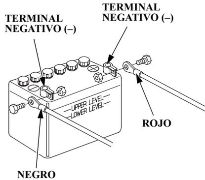
3. Conecte el cable positivo de la batería (+) al terminal positivo de la misma (+) y luego el cable negativo (-) al terminal negativo de la misma (-). Apriete pernos y tuercas con seguridad. Recubra los terminales de la batería con grasa.
