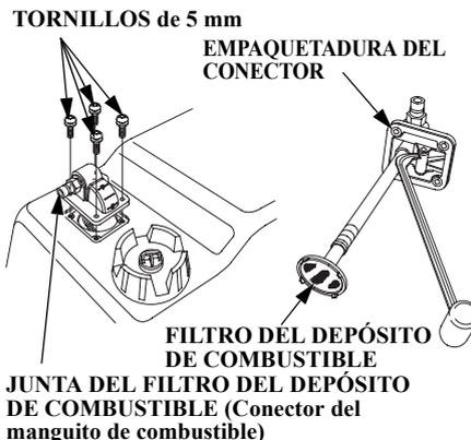
1. Extraiga los cuatro tornillos de 5 mm utilizando un destornillador de punta plana, luego extraiga el conector de la manguera de combustible y el filtro del depósito de combustible desde el depósito.
