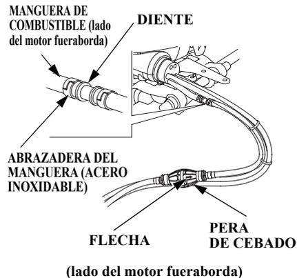
1. Extraiga el tapón de manguera de la manguera de combustible del lado del motor. Inserte la junta de la línea de combustible en la manguera de combustible del lado del motor y fijela con la abrazadera de la manguera. Asegúrese de que la marca de la flecha de la pera de cebado señale hacia el lado del motor.
