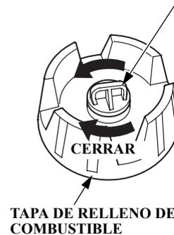
2. Cierre con seguridad la tapa de relleno de combustible y la perilla de ventilación.
