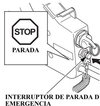
Presione el interruptor de parada de emergencia para detener el motor.
