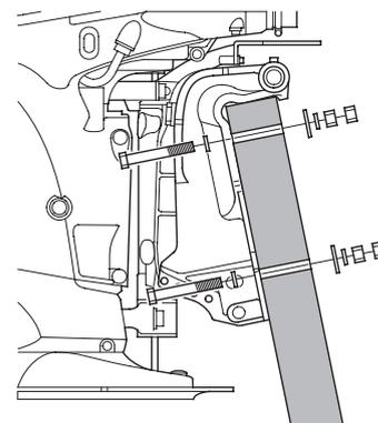
3. Fije el motor fueraborda en un soporte de motor fueraborda con los pernos y las tuercas de montaje.
