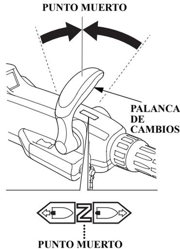
2. Mueva la palanca de cambios a la posición NEUTRAL. El motor no arrancará a menos que la palanca de cambios esté en la posición de PUNTO MUERTO.
