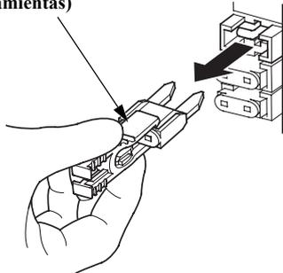
3. Extraiga la tapa de la caja de fusibles y extraiga el fusible viejo con el extractor de fusibles suministrado en la bolsa de herramientas.
