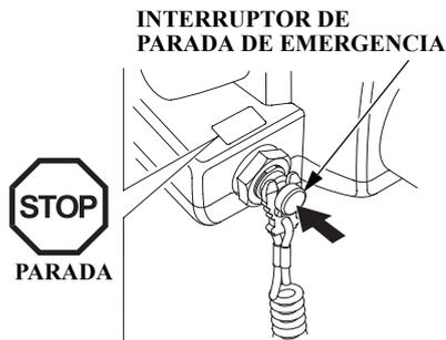
Presione el interruptor de parada de emergencia para detener el motor.
