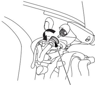
CONECTOR DEL ORIFICIO DE LAVADO
