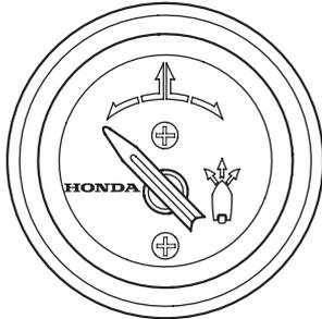
El medidor del timón muestra la dirección de navegación de la embarcación de acuerdo con el ángulo del timón.
