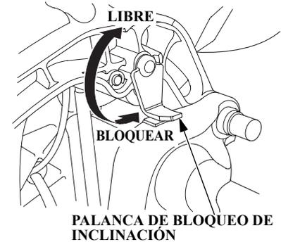
Emplee la palanca de bloqueo de la inclinación para elevar el motor fueraborda y bloquearlo en la posición cuando la embarcación esté amarrada o se deje anclada durante períodos prolongados.
