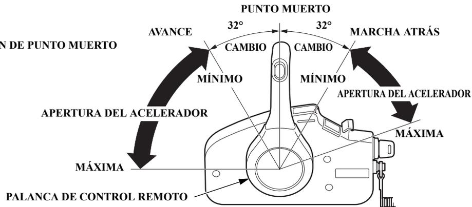
Con el cambio en posición de avance, marcha atrás, o punto muerto, se puede realizar el ajuste del régimen del motor con la palanca de control remoto. Es necesario tirar hacia arriba de la palanca de liberación de punto muerto para accionar la palanca de control remoto.
