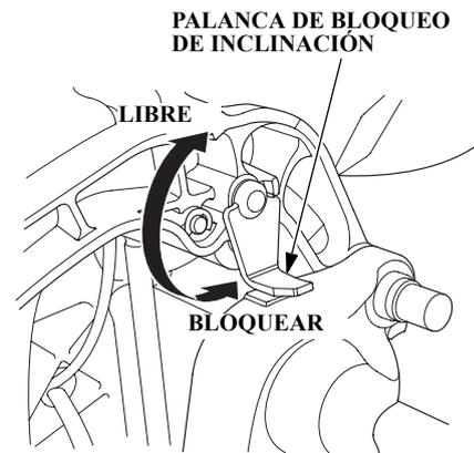
1. Levante el motor fueraborda todo lo posible empleando el interruptor de trimado/inclinación motorizados.
