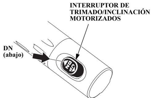
1. Presione la parte DN (abajo) del interruptor de trimado/inclinación motorizados y efectúe el trimado del motor fueraborda a la posición más baja.
