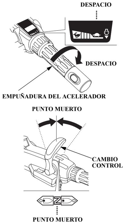
1. Gire la empuñadura del acelerador a la posición LENTO y mueva la palanca de cambios a la posición de PUNTO MUERTO.
