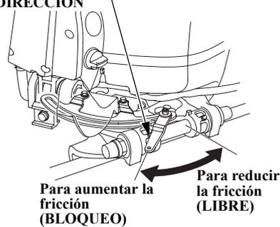
El ajustador de la fricción del timón ajusta la resistencia del timón.
