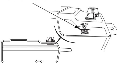
Compruebe el medidor de combustible, y llene el depósito hasta la marca de nivel superior si es necesario. No llene el depósito de combustible por encima de la marca de nivel superior UPPER.
