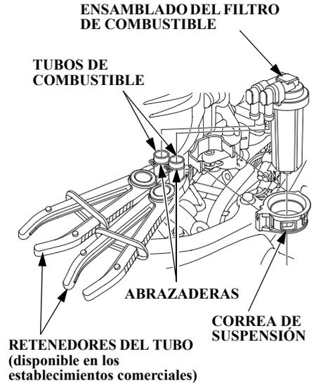
2. Desconecte los tubos de combustible del conjunto del filtro de combustible.
