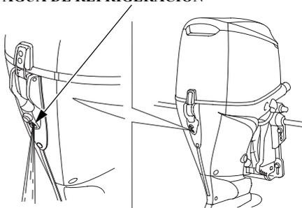
Aquí se comprueba si el agua de refrigeración circula adecuadamente dentro del motor.
