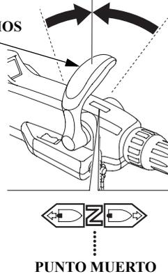
Esta caña del timón está equipada con un interruptor del motor del tipo de automóvil.
