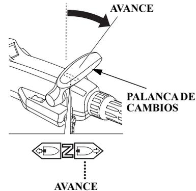
2. Con la palanca de cambios en la posición AVANCE.
