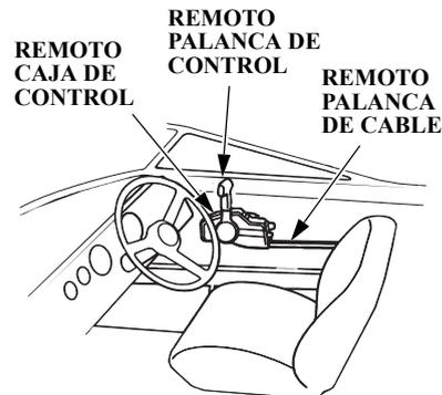
Instale la caja de control remoto en una posición en la que sea fácil de operar la palanca de control remoto y el interruptor. Asegúrese de que no existen obstáculos en la ruta del cable de control.
