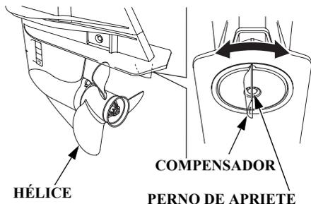
Si se gira la manija/timón de dirección hacia un lado mientras se navega a toda velocidad, ajuste el compensador para que la embarcación navegue hacia delante en línea recta.
