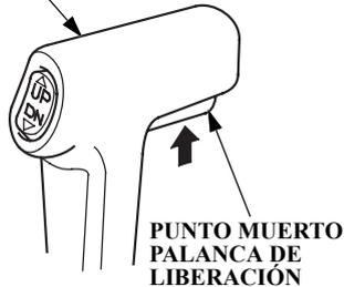
La palanca de liberación de punto muerto se ajusta en la palanca de control remoto para evitar el accionamiento accidental de la palanca de control remoto.
