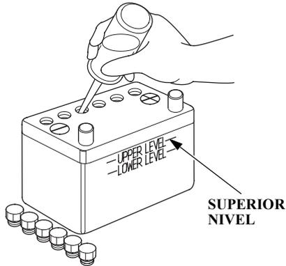
3. Llene la batería con agua destilada hasta la línea de nivel superior. Nunca llene demasiado la batería.
