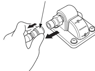
1. Desconecte el conector del conjunto del tubo de combustible del depósito de combustible (vea la página 107).
