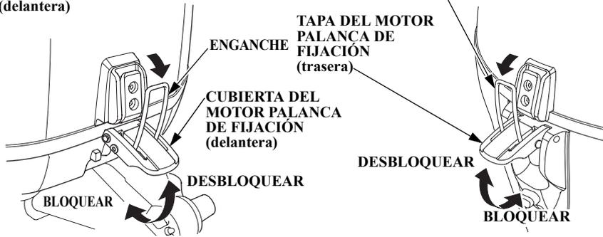
Cierre/abra la palanca de fijación de la tapa del motor para instalar o extraer la tapa del motor.
