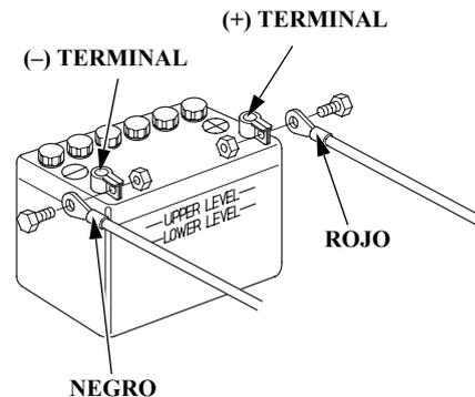
1. Desconecte el cable de la batería en el terminal negativo de la misma (-) y luego en el terminal positivo de la batería (+).
