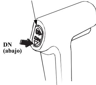
1. Presione DN (abajo) del interruptor de trimado/inclinación motorizados y efectúe el trimado del motor fueraborda a la posición más baja.
