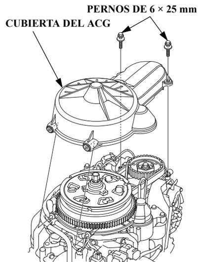
3. Extraiga los dos pernos de 6 x 25 mm, y luego extraiga la cubierta del ACG.
