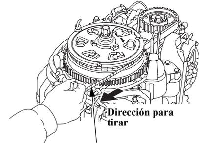
9. Tire ligeramente de la cuerda del arrancador de emergencia hasta notar resistencia, y entonces tire con fuerza en la dirección de la flecha como se muestra arriba.
