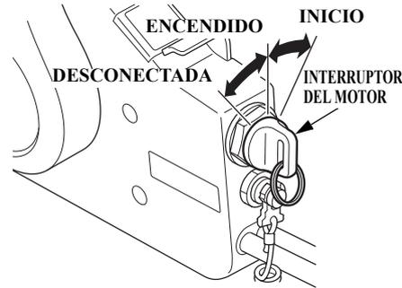
Este control remoto está equipado con un interruptor de motor del tipo para automóviles.
