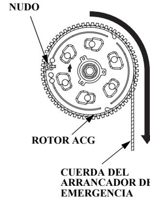
6. Coloque el rotor del ACG de modo que los cortes estén en los lados derecho e izquierdo del rotor del ACG como se muestra. Enganche el nudo del extremo de la cuerda del arrancador (accesorio) en un corte del rotor del ACG y bobine la cuerda del arrancador una vuelta y media hacia la derecha a lo largo de la ranura del rotor del ACG.
