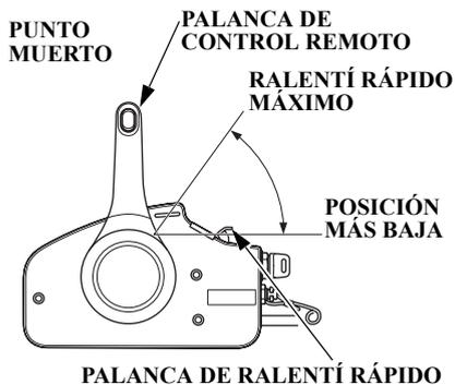
La palanca de ralenti rápido no se moverá a menos que la palanca de control remoto esté en la posición de PUNTO MUERTO. Por el contrario, la palanca de control remoto no se moverá a menos que la palanca de ralenti rápido esté en la posición más baja.
