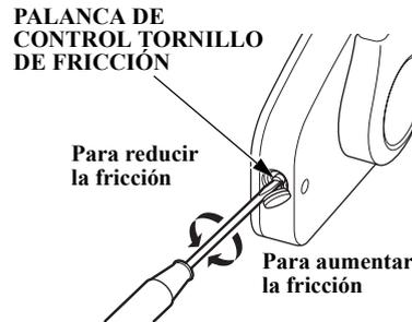
Compruebe si la palanca de control remoto se mueve suavemente. La fricción de la palanca de control se puede ajustar girando el ajustador de fricción de la palanca de control a derecha o izquierda.
