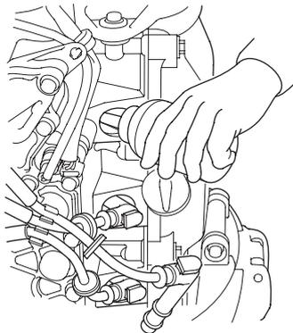
5. Introduzca una cucharada de aceite de motor en el orificio de cada bujía, y tire varias veces de la cuerda de arranque de emergencia para lubricar el interior de los cilindros. Vuelva a instalar las bujías.
