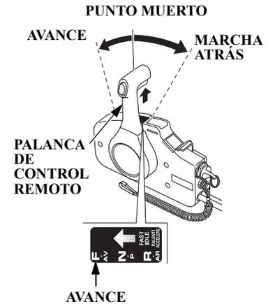
2. Mueva la palanca de control remoto desde la posición NEUTRAL de punto muerto a la posición FORWARD de avance.
