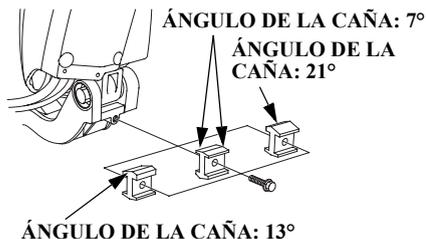
Instale bloque de ajuste de la altura para que el ángulo seleccionado de la caña del timón quede en esta posición.
