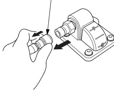
1. Mientras tira de la cubierta del conector del conjunto del tubo de combustible, tire del conector del conjunto del tubo de combustible para desconectarlo del depósito de combustible.
