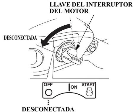
2. Gire la llave del interruptor del motor a la posición OFF para parar el motor.
