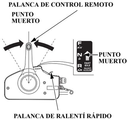
2. Coloque la palanca de control remoto en la posición de punto muerto. El motor no arranca a menos que la palanca de control remoto se encuentra en la posición de PUNTO MUERTO.
