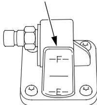
El indicador de combustible indica el nivel de combustible en el depósito.
