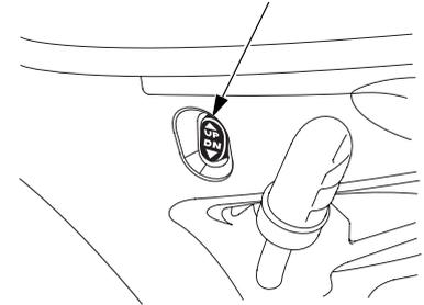
Cuando esté alejado del interruptor de trimado/inclinación motorizados de la palanca de control o del lado de la caña del timón, podrá operar el interruptor de inclinación motorizada del lado del motor fueraborda.
