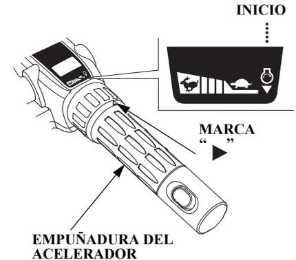
3. Alinee la marca "⚙" (marca de arranque) de la caña del timón con el extremo salido de la marca "►" de la empuñadura del acelerador.
