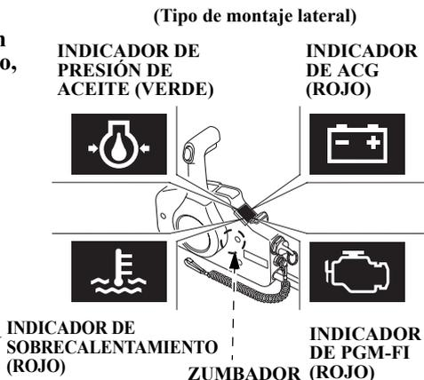
Si se reduce la presión del aceite de motor y/o se sobrecalienta el motor, puede activarse uno o ambos sistemas de advertencia.
