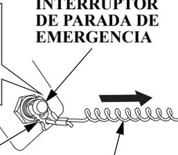
Tire del acollador del interruptor de parada de emergencia y extraiga el retenedor del interruptor de parada de emergencia del interruptor, de este modo se parará el motor.
