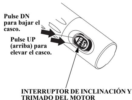
El sistema de estibado/inclinación motorizados opera cuando se presiona el interruptor, y se para cuando se suelta el interruptor. Para estibar un poco hacia arriba, presione UP (arriba) momentáneamente pero con seguridad. Para estibar hacia abajo ligeramente, presione en la porción DN (abajo) de la misma manera.
