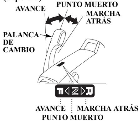
Utilice la palanca de cambios para hacer marchar la embarcación hacia adelante o hacia atrás, o para cortar la potencia del motor a la hélice. La palanca de cambios tiene tres posiciones.
