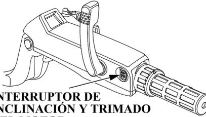
INTERRUPTOR DE INCLINACIÓN Y TRIMADO DEL MOTOR
