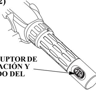
INTERRUPTOR DE INCLINACIÓN Y TRIMADO DEL MOTOR
