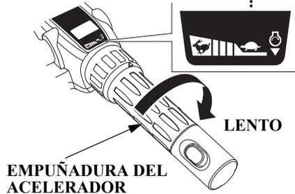
1. Alinee el indicador del timón con la posición LENTO de la empuñadura del acelerador para reducir la velocidad del motor.
