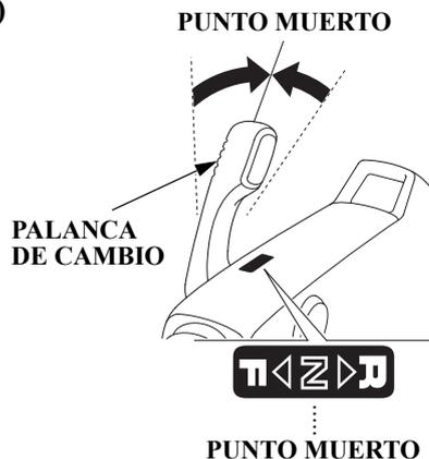
1. Gire la empuñadura del acelerador a la posición LENTO y mueva la palanca de cambios a la posición de PUNTO MUERTO.
