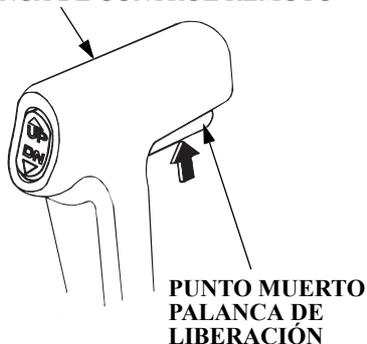
Cambiar a marcha adelante, marcha atrás o punto muerto y el ajuste de la velocidad del motor puede realizarse con la palanca de control remoto. Es necesario tirar de la palanca de liberación de punto muerto para operar la palanca de control remoto.
