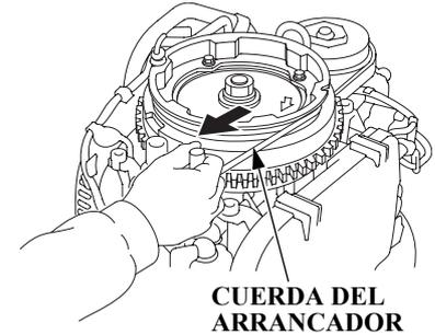
3. Extraiga las bujías. Retire la tapa del volante de motor y bobine la cuerda del motor de arranque de emergencia según el procedimiento de arranque de emergencia (páginas 79 a 83) y drene el agua del cilindro tirando varias veces de la cuerda del motor de arranque de emergencia.
