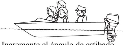
Incremente el ángulo de estibado presionando la parte de UP (arriba) del interruptor de estibado/inclinación motorizados.
