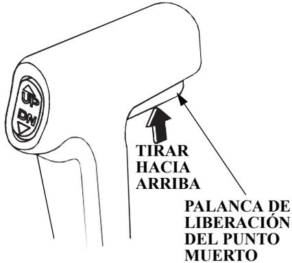
La palanca de liberación de punto muerto está puesta en la palanca de control remoto para impedir un accionamiento involuntario de la palanca de control remoto. La palanca de control remoto no funcionará a menos que sea movida mientras se empuja la palanca de liberación de punto muerto hacia arriba.
