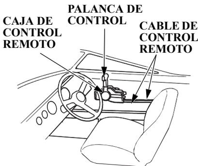
Instale la caja de control remoto en una posición en la que sea fácil de operar la palanca e interruptores de control. Asegúrese de que no existen obstáculos en la ruta del cable de control.
