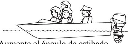
Aumente el ángulo de estibado presionando UP (arriba) en el interruptor de estibado/inclinación motorizados.
