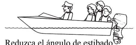
Reduzca el ángulo de estibado presionando DN (abajo) en el interruptor de estibado/inclinación motorizados.
