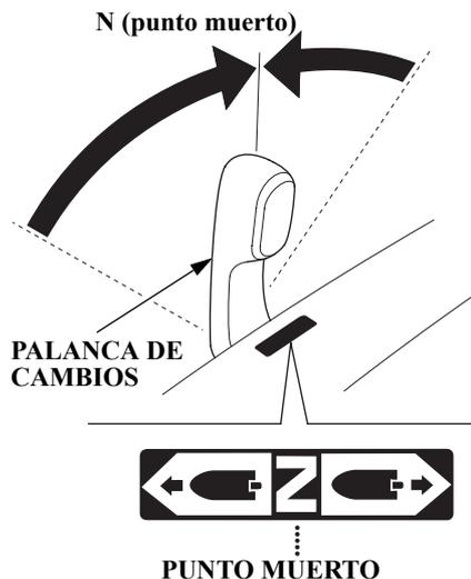
2. Mueva la palanca de cambios a la posición N (neutral). El motor no arrancará a menos que la palanca de cambios esté en la posición N (punto muerto).
