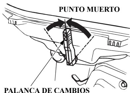
1. Mueva la palanca de cambios a la posición de NEUTRAL (PUNTO MUERTO) y detenga el motor.
