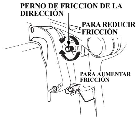
El perno de fricción de la dirección ajusta la resistencia de la dirección.
