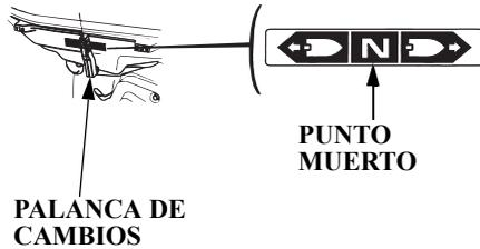
2. Mueva la palanca de cambios a posición de PUNTO MUERTO. El motor de arranque de retroceso no podrá accionarse a menos que la palanca de cambios esté ajustada en posición de PUNTO MUERTO.
