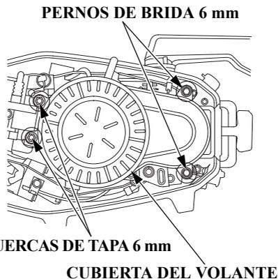
3. Extraiga las dos tuercas de tapa de 6 mm y los pernos de brida de 6 mm, y extraiga la cubierta del volante de motor.
