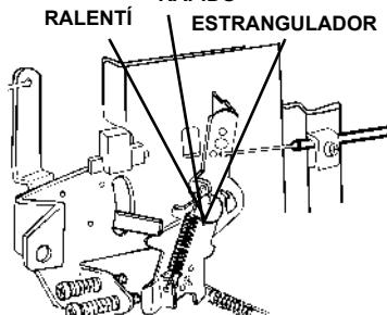
3. PARA VOLVER A ARRANCAR UN MOTOR CALIENTE: No utilice el estrangulador cuando el motor está caliente.
