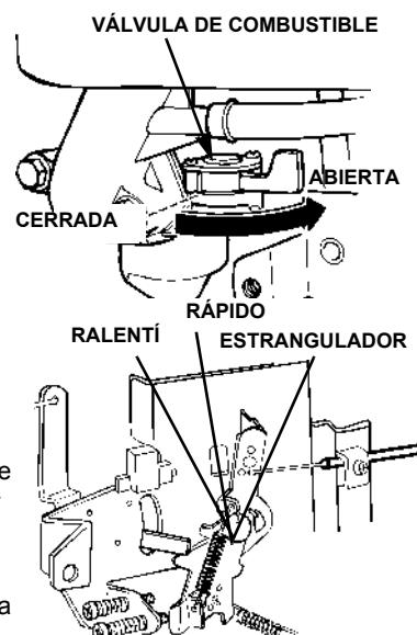
2. PARA VOLVER A ARRANCAR UN MOTOR FRÍO: Mueva la palanca del acelerador a la posición del estrangulador.
