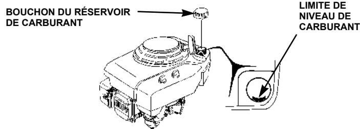
2. Ajoutez du carburant en dessous de la limite de niveau de carburant dans le goulot du réservoir. Ne remplissez pas avec excès. Nettoyez le carburant renversé avant de mettre le moteur en marche.
