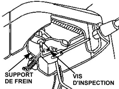
2. Si la vis d'inspection entre en contact avec le support de frein, emportez le moteur à un centre de services des moteurs agréé Honda qui inspectera le patin du frein de volant.
