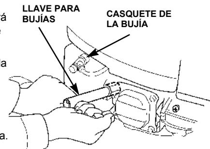
2. Utilice una llave de bujía de encendido del tamaño correcto para extraer la bujía.
