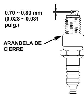
4. Mida la separación del electrodo con un calibrador adecuado. La separación correcta es 0,70 - 0,80 mm (0,028 - 0,031 pulg.). Si necesita ajustarla, corrja la separación con cuidado arqueando el electrodo lateral.
