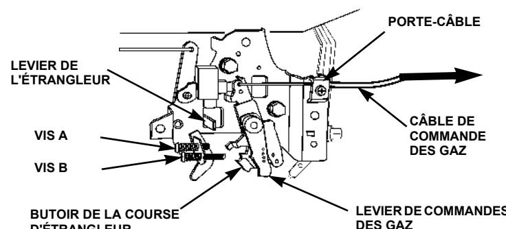
5. Déplacez la commande des gaz en position de l'étrangleur et vérifiez que la tige de l'étrangleur du moteur déplace le bras de l'étrangleur du carburateur en position totalement fermée. Si besoin, réglez la vis B de manière à ce qu'elle touche le butoir de course de l'étrangleur.
