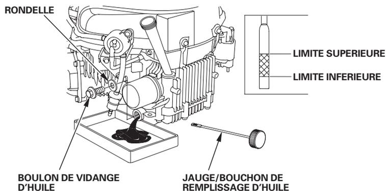
4. Remettre la jauge/bouchon de remplissage d'huile correctement en place.
