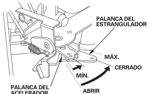
Algunas aplicaciones del motor emplean un control montado a distancia en lugar de la palanca montada en el motor aquí mostrada. Consulte las instrucciones suministradas por el fabricante del equipo.
