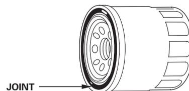
3. Nettoyer le socle de montage du filtre et enduire le joint d'un filtre à huile neuf avec de l'huile moteur propre.
