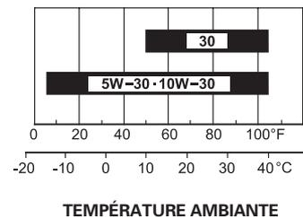
Une huile SAE 10W-30 est recommandée pour l'utilisation générale. Les autres viscosités indiquées dans le tableau peuvent être utilisées lorsque la température moyenne du lieu d'utilisation se trouve dans la plage indiquée.
