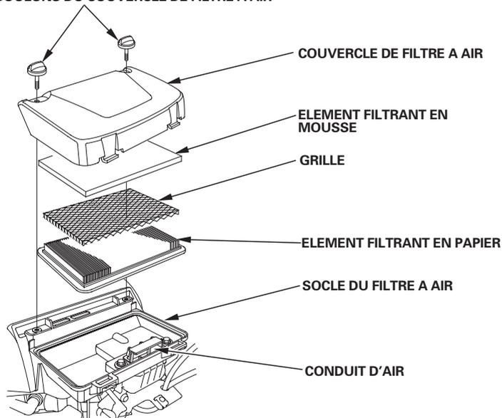
4. Contrôler les deux éléments du filtre à air et les remplacer s'ils sont endommagés. Toujours remplacer l'élément filtrant en papier aux intervalles prévus dans le programme d'entretien (voir page 6).
