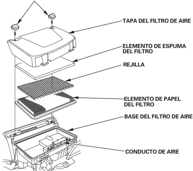
4. Inspeccione los dos elementos del filtro de aire, y reemplácelos si están dañados. Reemplace siempre el elemento de papel del filtro de aire a los intervalos programados (vea la página 6).
