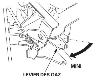
2. Placer l'interrupteur du moteur sur la position ARRÊT (OFF).
