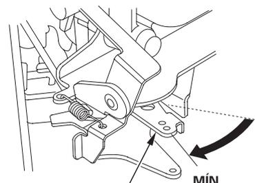
2. Gire el interruptor del motor a la posición DESCONEXIÓN (OFF).
