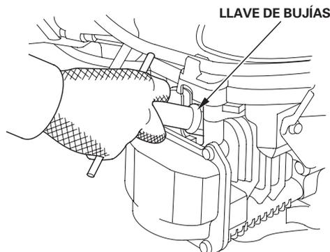
3. Inspeccione las bujías. Reemplácelas si están dañadas, muy sucias, si la arandela de sellado está en mal estado, o si el electrodo está gastado.
