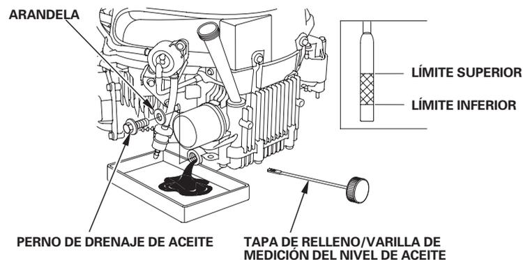
4. Instale con seguridad la tapa de relleno/varilla de medición del nivel de aceite.
