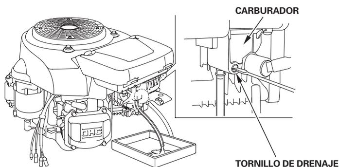
3. Después de haber drenado todo el combustible al recipiente, apriete con seguridad el tornillo de drenaje.
