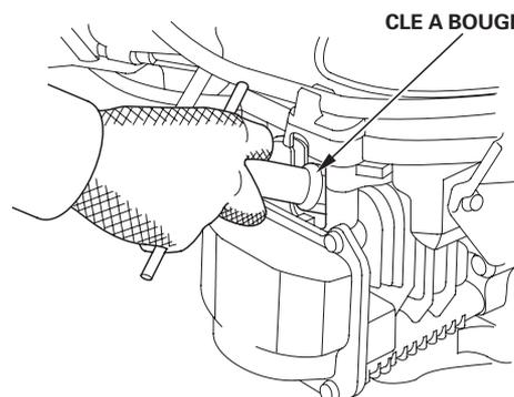
3. Contrôler les bougies. Les remplacer si elles sont endommagées, très encrassées, si leur rondelle d'étanchéité est en mauvais état ou si leur électrode est usée.
