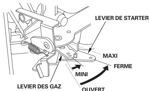
Certaines applications du moteur utilisent une commande à distance plutôt que le levier sur le moteur représenté ici. Consulter les instructions fournies par le fabricant de l'équipement.
